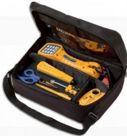
Los Electrical Contractor Telecom Kits de Fluke Networks están formados por herramientas y equipo de comprobación de telecomunicaciones estándar del sector, en una funda resistente. Los kits se diseñan para los técnicos que instalan, comprueban y solucionan problemas de las líneas de teléfono y de datos.
