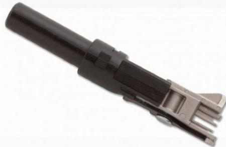
La cuchilla Krone Blade modelo 110 de Fluke Networks es un accesorio opcional para las herramientas automáticas de impacto D814, D914 y D914S. Dually Combination Blade es para usar en el sistema Krone y en 110 bloques y realizará recortes de acción de tijera y terminaciones de perforación en una sola operación.
